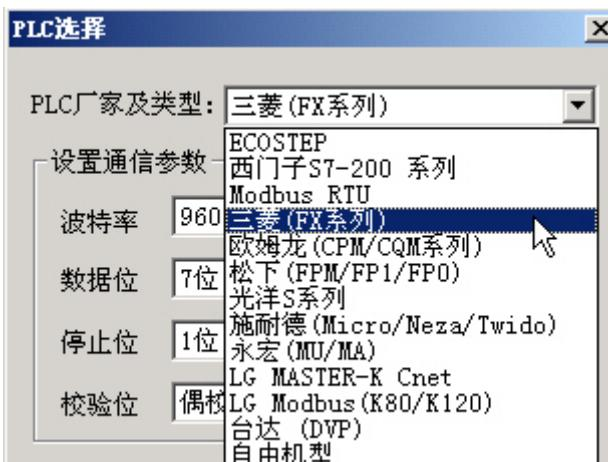
在这个窗口选择了正确的 PLC、波特率、数据位、停止位和校验位。
