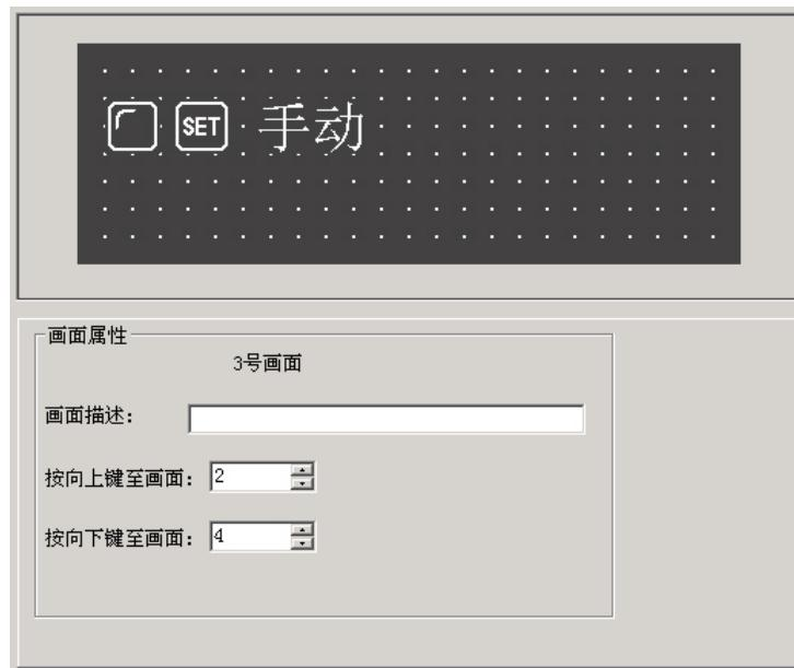
以同样方法设置手动按键，手动状态指示灯。指示灯的地址仍然对应 M10，显示属性取负逻辑。
