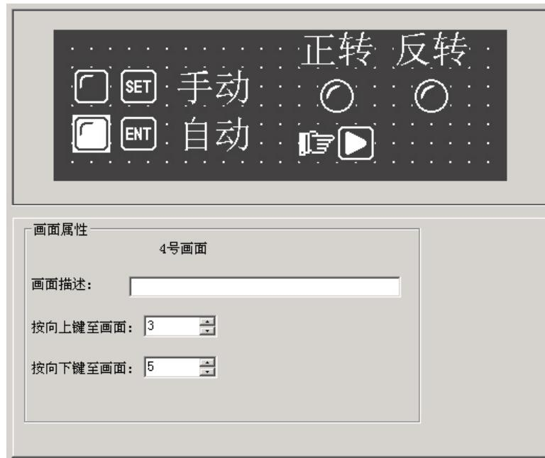
按 键，放置功能键，选择“<”按键，地址对应 M21，功能为瞬时设置 M21 继电器 ON，保留手形。表示按下“<”按键时，PLC 的 M21 被置 ON，电机开始反转（PLC 编程，用 M21 触发 Y1）；
