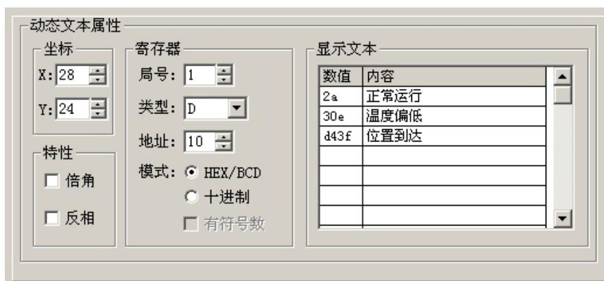
例：如图显示 D10 控制的动态文本，显示文本有三个状态“正常运行”“温度偏低”和“位置到达”分别对应的 D10 寄存器值为 16 进制数 2a, 30e, 和 d43f。在显示文本设定中第一条数值栏输入“2a”，右侧内容中输入“正常运行”四个字，依次输入其它两条。当 D10 的数值为 2a 时，文本显示为“正常运行”，当值为 30e 时显示“温度偏低”，其余依此类推。
