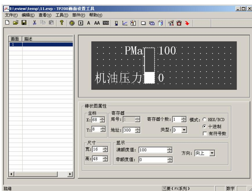
该棒形图监视 D300 中的数据，当棒形图满刻度显示时，表示 D300 中的数据为 100；当棒形图 50%刻度显示时，表示 D300 中的数据为 50。
